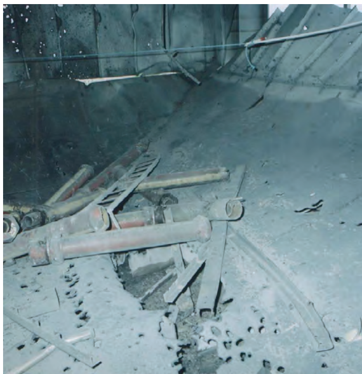
Figura 2. Apertura nel pavimento prodotta da un test di esplosione in una nave.
