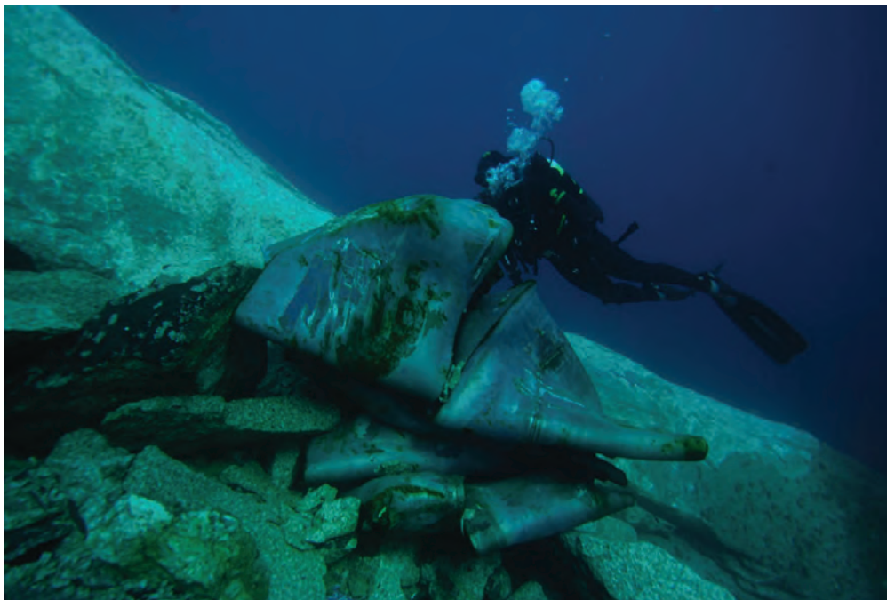
Figura 75 – Aletta antirollio appartenente alla Costa Concordia rinvenuta in prossimità del punto di impatto.
