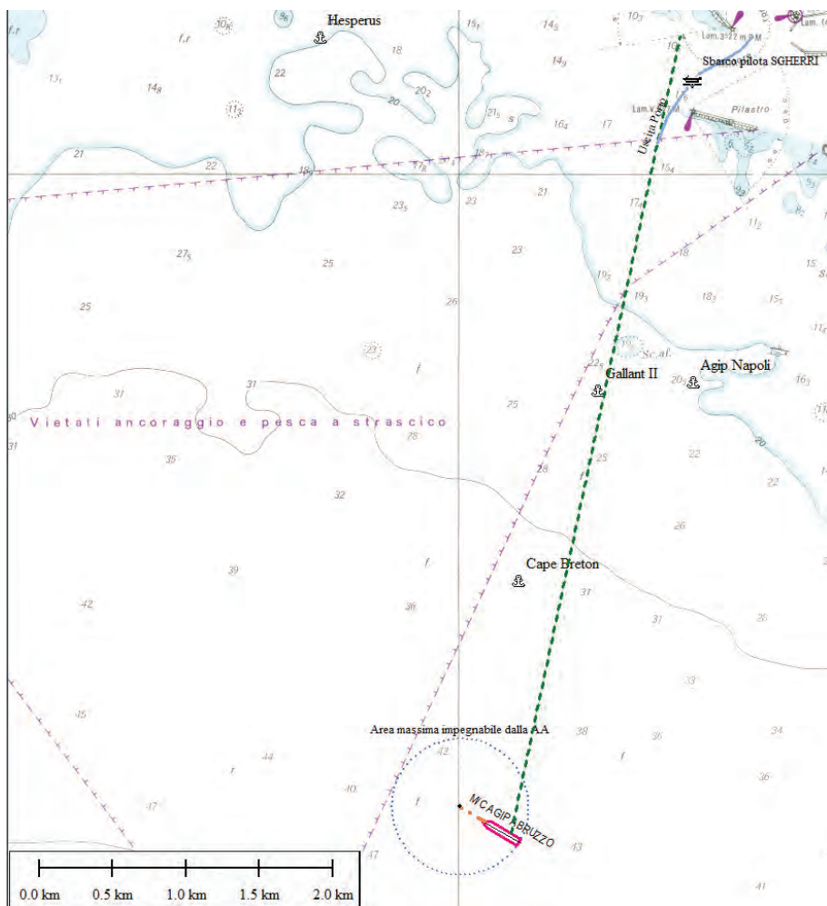
Figura 71 -Ipotesi ricostruttiva traiettoria del MOBY PRINCE con rotta 192° e con AGIP ABRUZZO ancorata nel punto B (cfr. Allegato 1).
