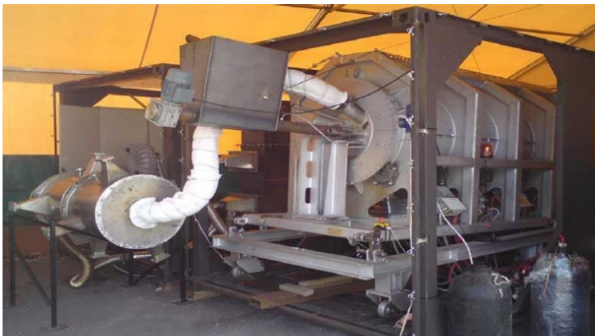
Impianto di inertizzazione dell'amianto
